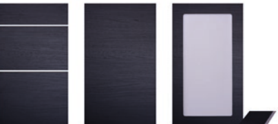
752 Miami sort eg ■ 16 mm spånplade belagt med melamin med sort egestruktur. Vandret åretegning på fronter – lodret åretegning på friser. 0,8 mm ABS kant med sort egestruktur. Matteret glas i vitrinelåger.
