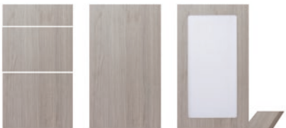
732 Madrid grå eg ■ 16 mm spånplade belagt med melamin med grå egestruktur. Lodret åretegning på alle fronter samt friser. 0,8 mm ABS kant med grå egestruktur. Matteret glas i vitrinelåger.
