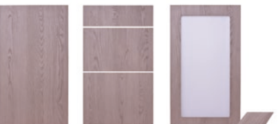
87 Riga grå eg ▼ ■ 19 mm spånplade med slagfast melaminbelægning med synkron struktur, der følger årerne. Solid 0,8 mm ABS kant. Matteret glas i vitrine.
