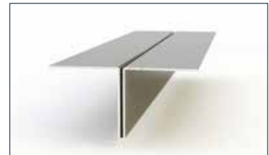
9. Cembrit T-Samleprofil, lodret 25 x 30 x 30 mm farvet aluminiumsprofil til lodret samling af Cembrit planker og Cembrit paneler.
