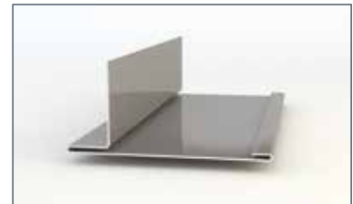
6. Cembrit Lysningsprofil, lodret (stor) 40 x 21 x 79 mm farvet aluminiumsprofil til lodrette afslutninger omkring vinduer og døre.
