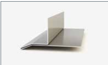
7. Cembrit Lysningsprofil, vandret (stor) 40 x 50 x 40 mm farvet aluminiumsprofil til vandret afslutning over vinduer og døre.
