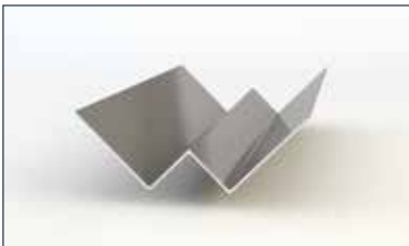
4. Cembrit Indvendigt Hjørne, kvadrat 20 x 35 x 35 mm farvet aluminiumsprofil til 90° hjørner.
