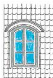
Kvist med buet tag, indklædt med zink, kobber eller pap.
