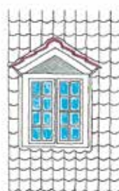
Heltagskvist i bindingsværk og med tegl på tag.
