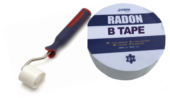
Fig. 09: Jackon Radon Barrier samles med Jackon Radon B tape. Dugen samles med minimum 15 cm overlap. Anvend udglatte rulle for at sikre at alle samlinger er tætte.
